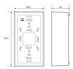
Abstände zwischen Aufputzgehäuse und Wand müssen mit Unterlegscheiben ausgeglichen werden. Die Schrauben niemals mit einem Akkuschrauber anziehen, sondern nur von Hand. Wird das nicht beachtet, kann sich das Aufputzgehäuse verziehen.
